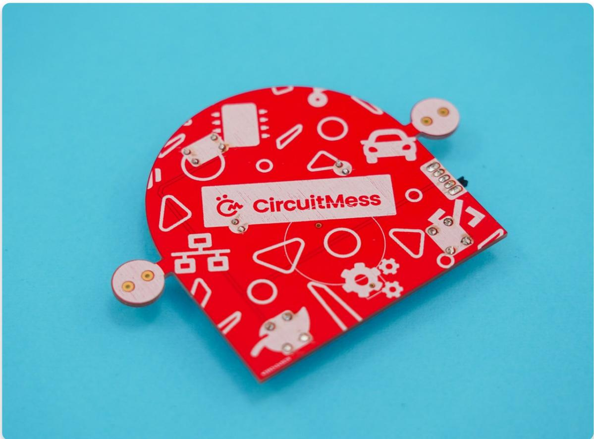
Examine encore une fois tuos les joints de soudure pour t'assurer qu'il n'y a pas de joints froids ou de pontage.
