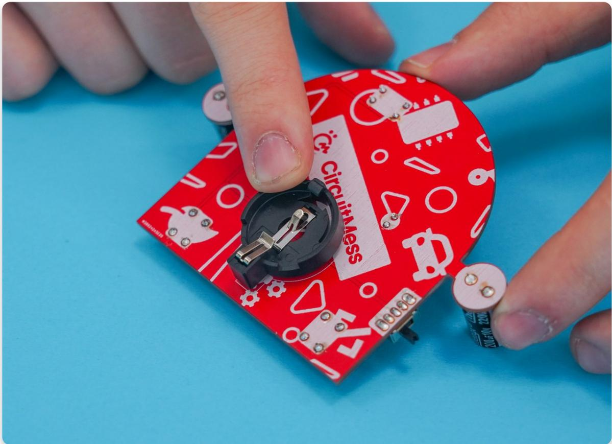
Maintenant, retourne le CAPACITRON et soudons les deux broches du support de la pile.
