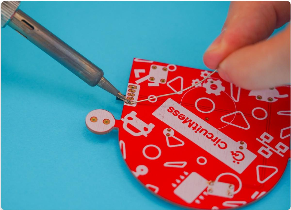
Les soudures de l'interrupteur doivent ressembler à ceci après que tu les aies soudées avec succès:
