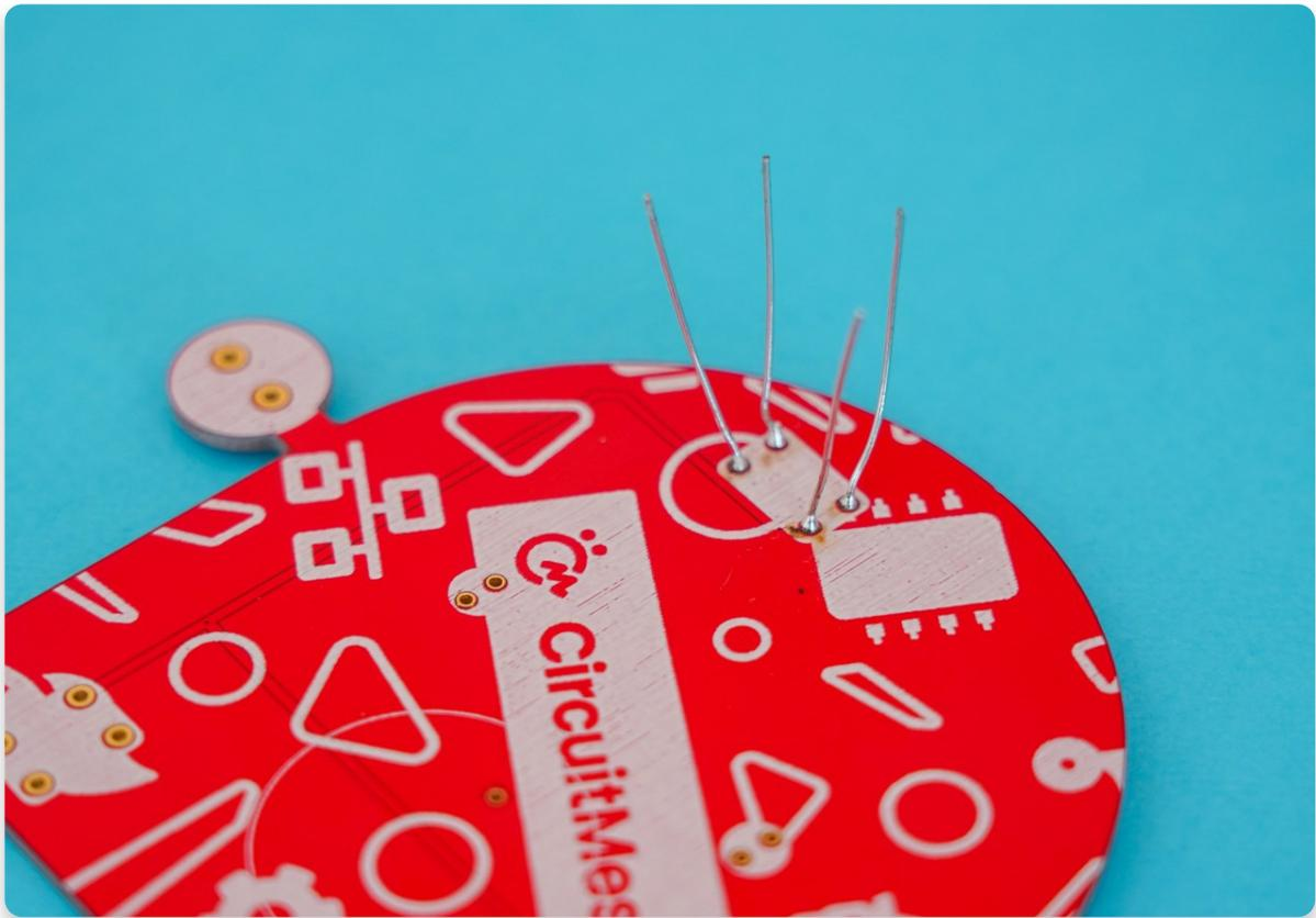
Après avoir soudé toutes les résistances, examine encore une fois les joints de soudure pour t'assurer qu'il n'y a pas de joints froids.
