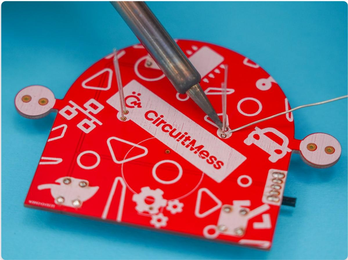
Après t'être assuré qu'il n'y a pas de pontage entre les soudures, prends ta pince et coupe le reste des pattes des DEL dont tu n'as pas besoin.
