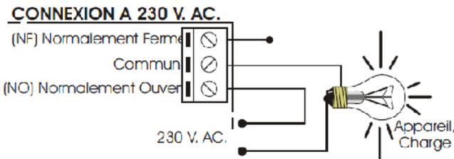
**CONSIDERATIONS SUR LA SORTIE.** Durant le fonctionnement, et selon sa charge, il est possible qu'il se produise une fluctuation ou un fonctionnement incorrect de la sortie. Si cela venait à se produire, placez un circuit "anti-étincelles" entre les deux contacts du relais utilisés pour la connexion, comme il est indiqué sur le schéma.
