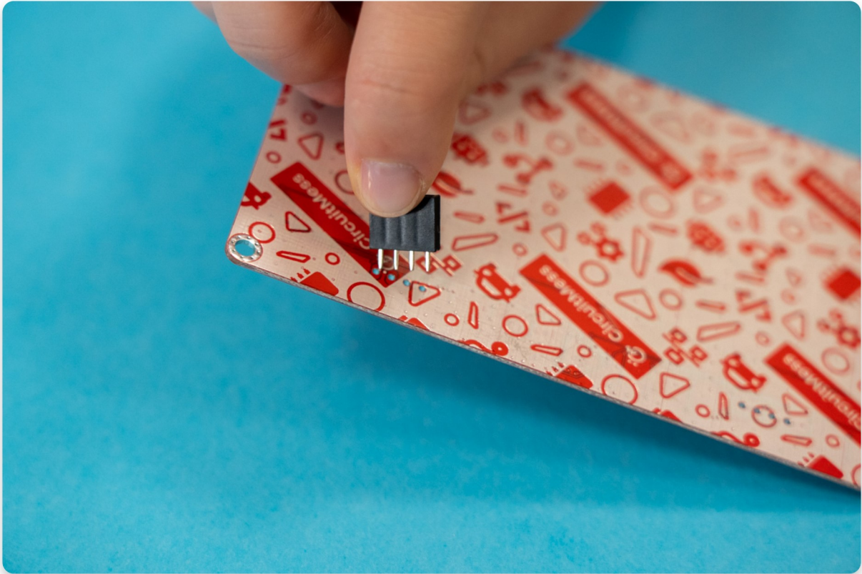
Insérez la tête de broche par l'arrière de la carte
