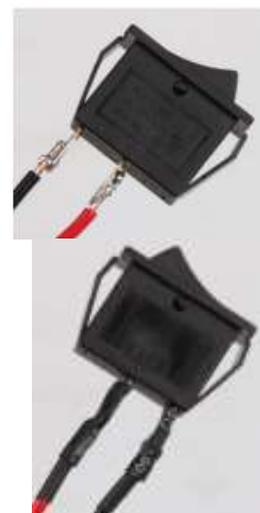
Maintenant que les fils sont soudés à l'interrupteur, coupez-les en laissant une longueur d'environ 9 cm. Il est impératif d'avoir minimum 9 cm afin de raccorder l'interrupteur à la carte électronique.
