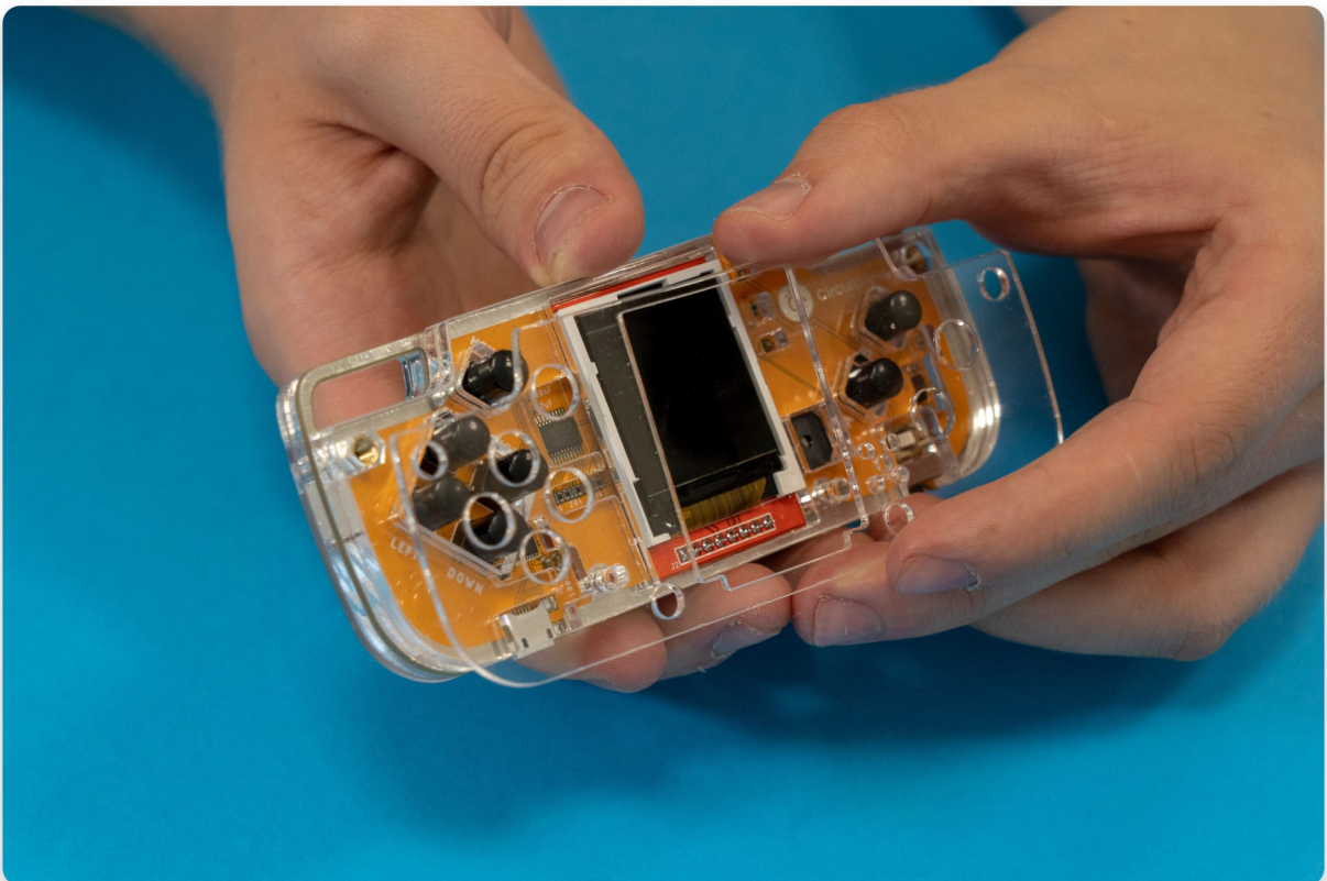
Placer la plaquette du dessus - la dernière plaquette du « sandwich »
