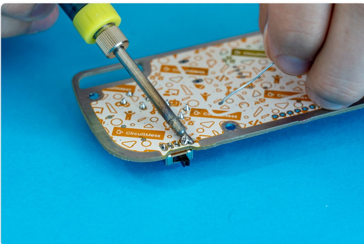
Exemple d'un pont de soudure
