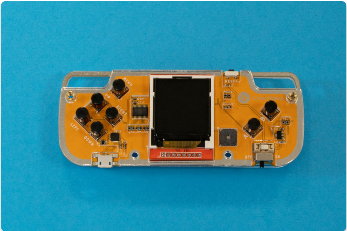
Les vis et les entretoises placées et serrées, vue de face
