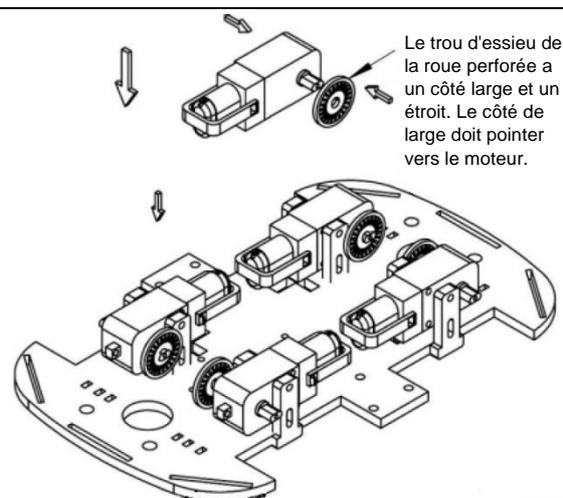
Fixer les moteurs avec les vis longues et les écrous.
