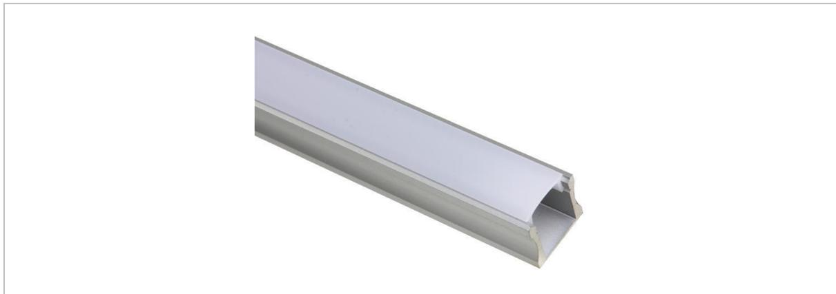
Un profilé avec cache diffus présente une perte de luminosité de 25 %. Pour un flux lumineux maximal, utilisez un profilé à cache transparent. Ces profilés présente une perte de luminosité de seulement 3 %.
