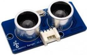
**Description** : mesurer la distance qui sépare le capteur d'un obstacle.
