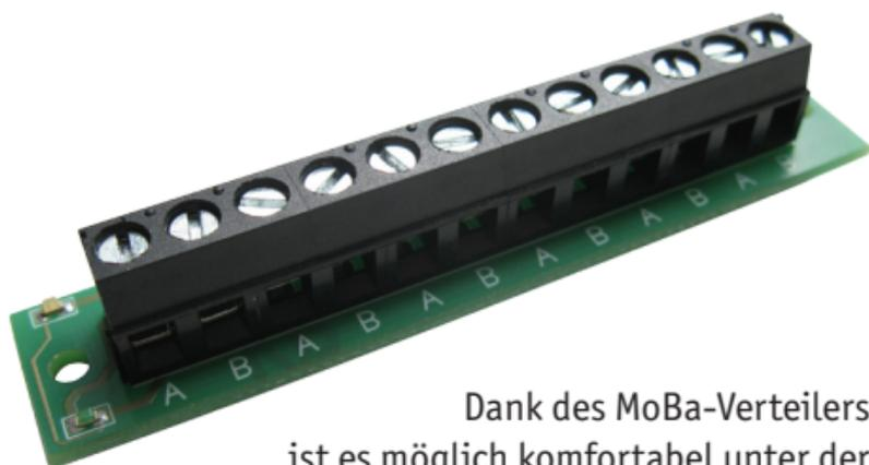
Dank des MoBa-Verteilers ist es möglich komfortabel unter der Modellbahnanlage zu verdrahten. Über die hochwertigen Schraubklemmen lassen sich schnell neue Verbraucher oder Gleisabschnitte mit Spannung versorgen.
