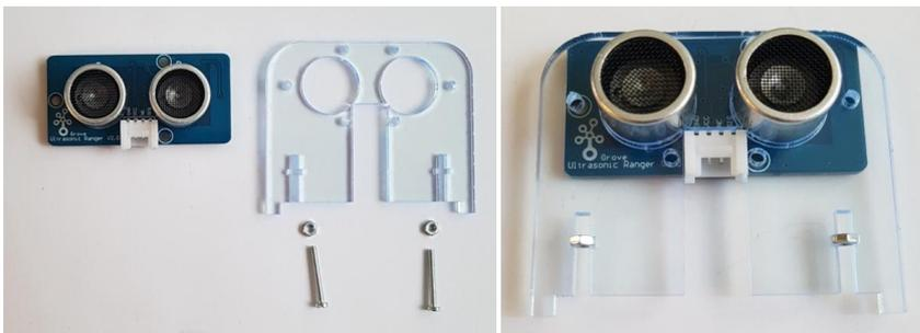
Fixation de la plaque : 2 vis Ø2 x h16 mm, 2 écrous Ø 2 mm.
