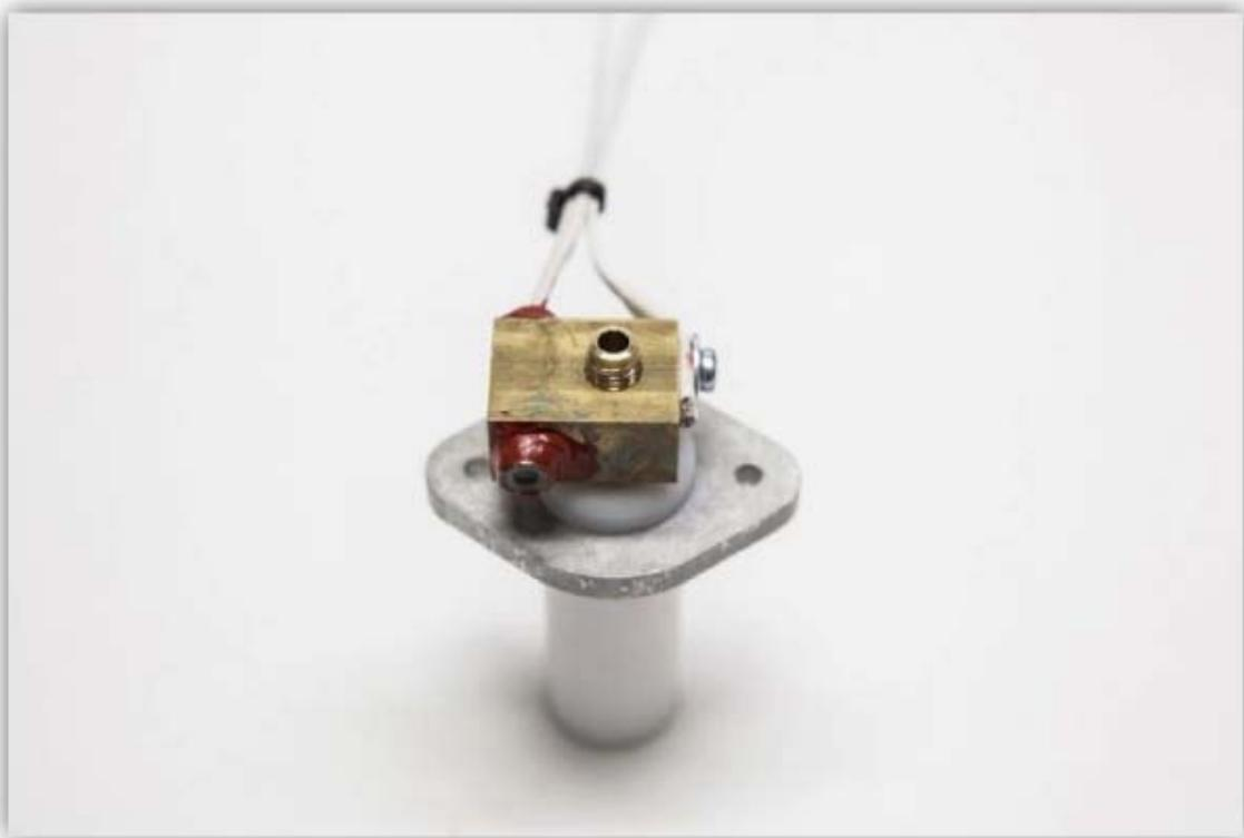
Visser le nez de l'extrudeur sur le bariillet. Bloquer solidement. Vous pouvez détacher le cylindre en plastique et utiliser une autre clé sur le bariillet en cuivre pour serrer fermement le nez. Ne pas oublier de rattacher solidement le cylindre en plastique par après.
