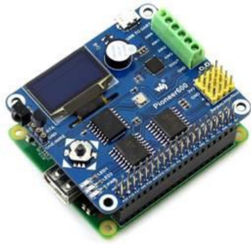
Carte placée sur un Raspberry Pi A+
