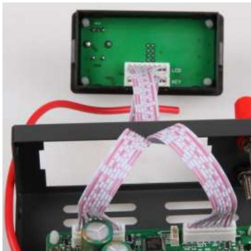
Les nappes se raccordent sur leurs connecteurs respectifs LCD et KEY. Ils comportent des détrompeurs évitant les inversions de sens.
