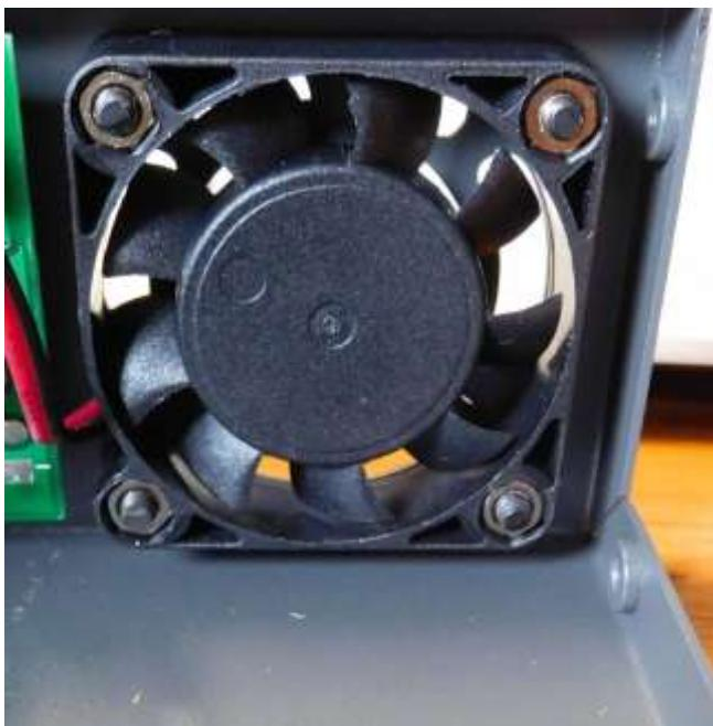
Le ventilateur se fixe simplement sur la partie arrière du châssis grâce aux longues vis et aux écrous inclus.
