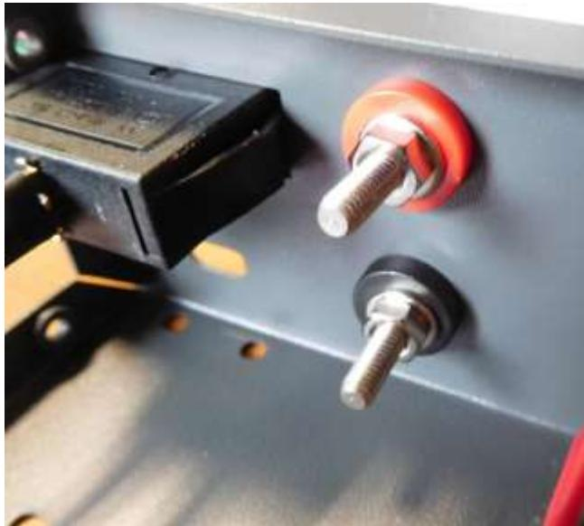
Fixation des socles bananes d'entrées et de sortie.
