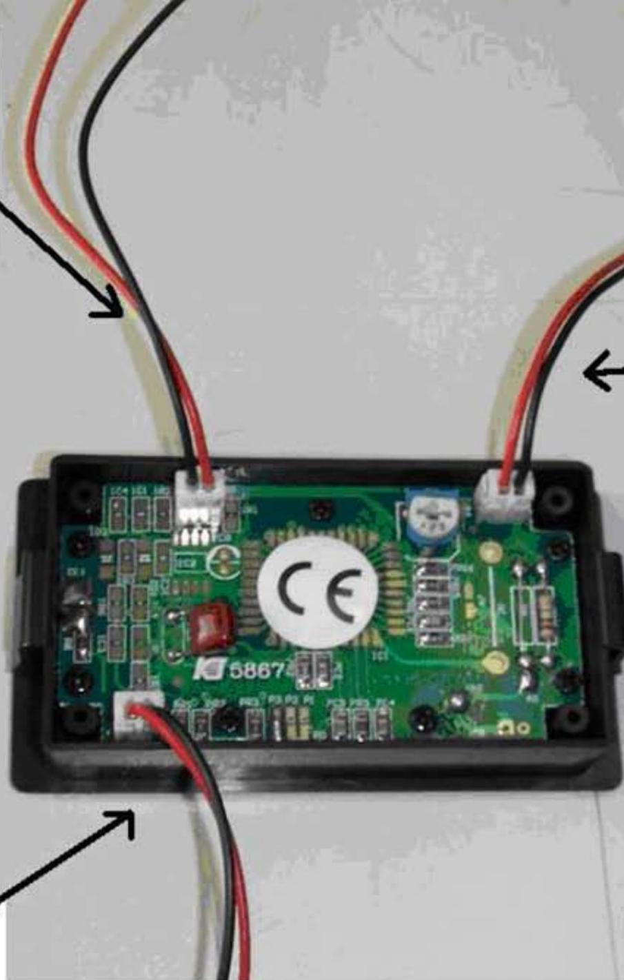
**Pour alimenter l'afficheur et le rétro-éclairage avec la même source, connecter uniquement le + du rétro-éclairage.**
