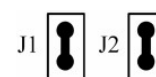
(d) J1 et J2 fermés mode CW/CCW et impulsion sur front descendant (NPN)
