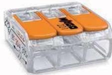
COMPACT-Verbindungsklemme für alle Leiterarten; 3-Leiter-Klemme; mit Hebeln; Dauergebrauchstemperatur max. 105 °C; Umgebungstemperatur max. 85 °C
