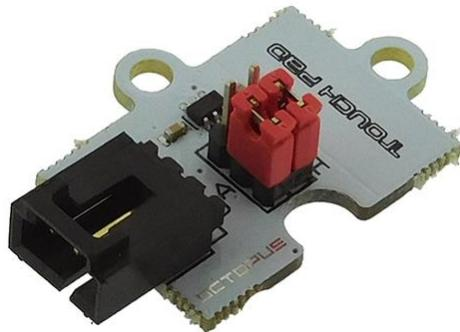
Mode maintien de la position, il sera nécessaire d'appuyer une seconde fois sur la partie tactile pour désactiver l'état haut (+Vcc) sur la sortie SIGNAL. Comportement comme un inverseur OFF-ON
