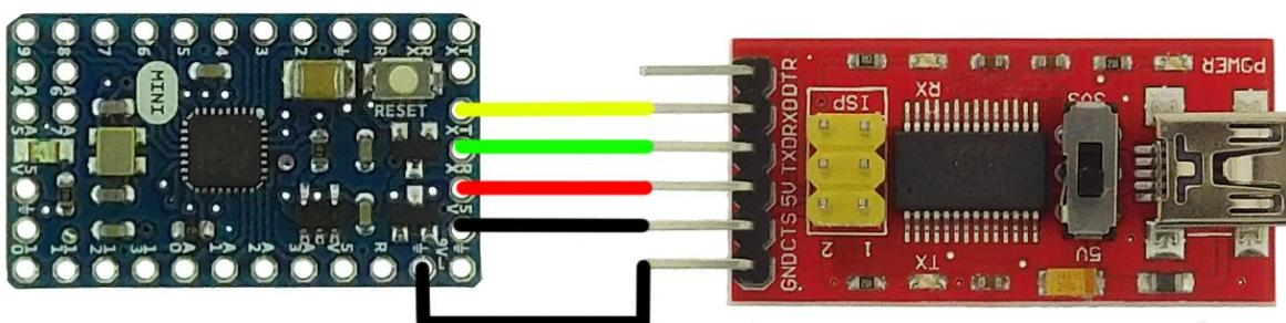
**Remarque :** dans cet exemple, lors du téléchargement du programme, il est nécessaire d'effectuer un reset manuel de l'Arduino®.
