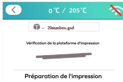
Etape 6: L'imprimante va vérifier le niveau du plateau avant l'impression. C'est automatique et ne requiert aucune opération de votre part.
