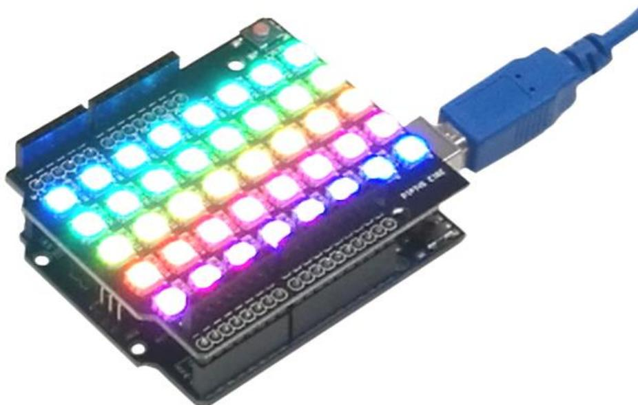
La matrice est composée de leds adressables et n'utilise qu'une seule sortie de l'Arduino pour les commander. L'accès au reste des broches de l'Arduino reste disponible sur le shield.
