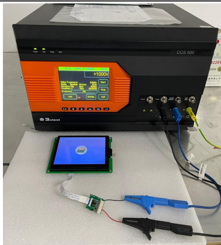
3.2 群脉冲测试图 EFT test
