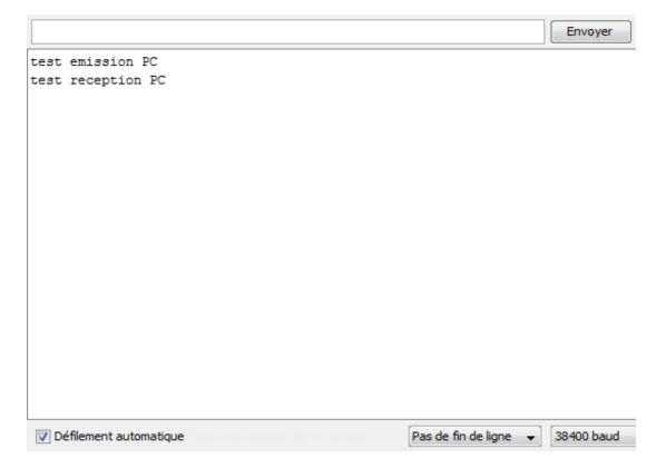
Il est maintenant possible de dialoguer entre le moniteur série du PC et le smartphone. La vitesse de transfert série doit être paramétrée sur 38400 bauds sinon une série de caractères illisibles apparaitra dans le moniteur.
