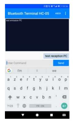
Il faudra ensuite installer sur le smartphone un programme comme <u>Bluetooth Terminal HC-05</u> pour Android et appairer le module HC-05. Le code pin par défaut est : 1234.
