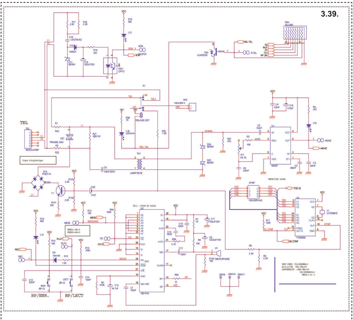
**3.40.** La synthèse vocale articulée autour de l'ISD1016, ISD1416 ou l'ISD2560 permet en mode autonome (avec un haut-parleur 8 ohms sur HP3) l'enregistrement et la diffusion de message grâce au BP ENR et BP LECT. La led s'illumine lorsque la mémoire est pleine. Le message reste enregistré même après la mise hors tension de la valise.
