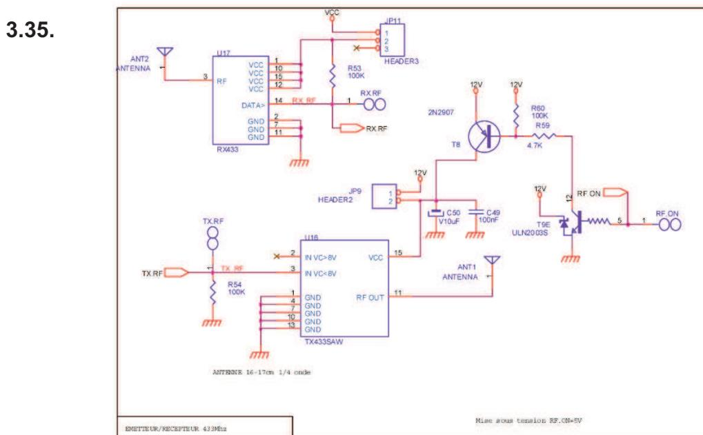
**3.36.** En mode émission le codeur injectera le signal codé sur l'émetteur radio par TX.S avec RT.S à 5V, en mode réception (mode=0V) le signal du récepteur radio entre par RX.S et active la sortie TX.S si le code correspond au code des cavaliers S7/S8. Ne pas oublier de mettre sous tension soit l'émetteur (JP9/On ou 5V sur RF.ON) soit le récepteur radio (JP11/1 et 2 relié).
