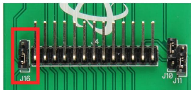
Lorsqu'il n'y a qu'un module, la configuration du bus SPI est par défaut.
