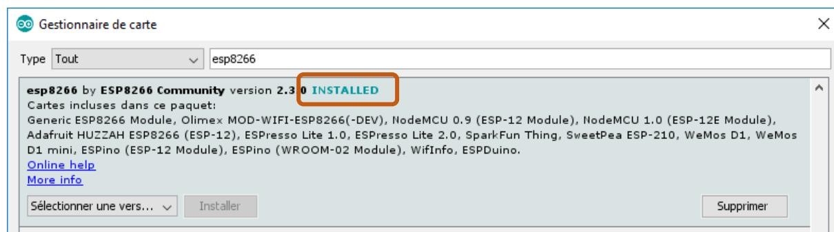
Le programme Arduino doit être paramétré pour le module ESP8266 :
